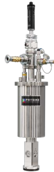
集成线性位移器的 VP-100 低温恒温器
